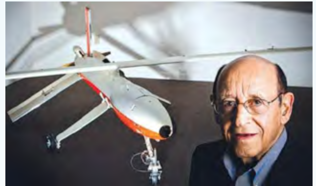
Figura 4. Prototipo UAV de Abraham Karem, llamado Albatross que sirvió de base para desarrollar el Predator, uno de los UAV de mayor éxito en la historia de Estados Unidos. Imagen tomada https://www.google.com/url?sa=i&url=https%3A%2F%2Fwww.uasvision.com%2F2017%2F04%2F07%2Fas-the-predator-retires-its-inventor-remembers-its-birth%2F&psig=AOvVaw3l-MDSoiC39y5laUnPb-&ust=1734715416128000&source=images&cd=vfe&opi=89978449&ved=0CBQQjRqFwoTCKDrytqstloDFQAAAAAdAAABAE
