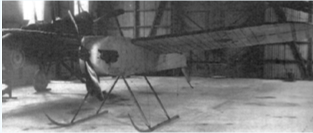
Figura 2. Primer avión no tripulado controlado por radio Imagen tomada de https://kids.britannica.com/students/article/Archibald-Montgomery-Low/315537
