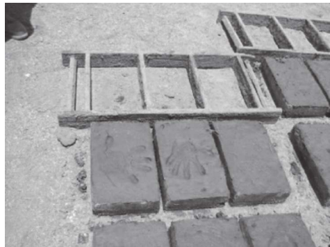
Imágenes 8 y 9. Llenado de molde en fabricación de adobes. Y moldes de madera
