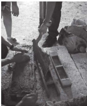
Imágenes 8 y 9. Llenado de molde en fabricación de adobes. Y moldes de madera
